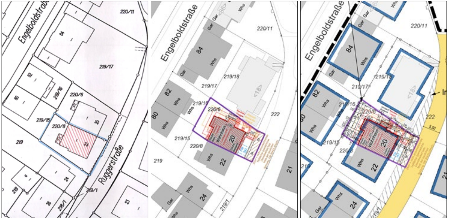
Links der Lageplan, wie er vor etwa 20 Jahren ausreichte. In der Mitte, wie er dieses Jahr eingereicht wurde, und rechts nach den Forderungen des Baurechtsamts
